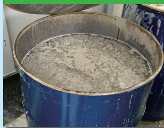
回収した石綿スラッジを保管 B
